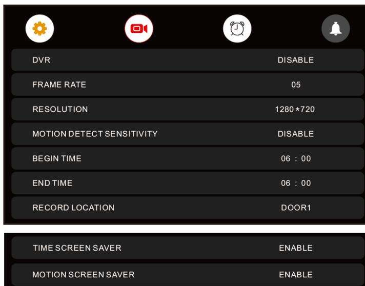
Функция автоматической записи по детектору движения: Включите пункт DVR. Вы можете реализовать запись от любого источника видео, подключенного к монитору. Вы можете задать интервал времени, когда будет производиться запись.
